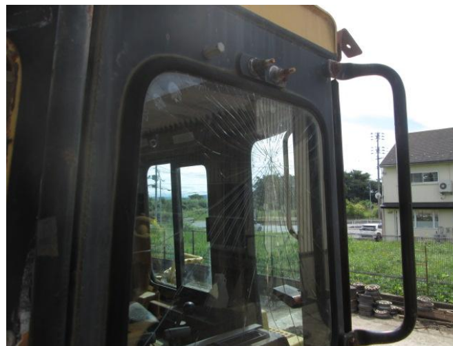
キャビンフロントガラス破損状況
