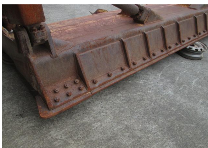
排土板エッジ状況
