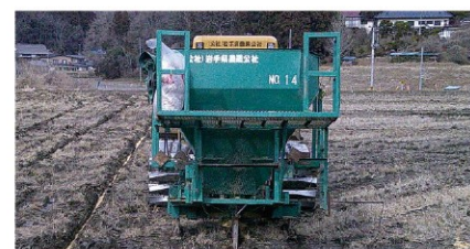
INK工法（補助暗渠工）
