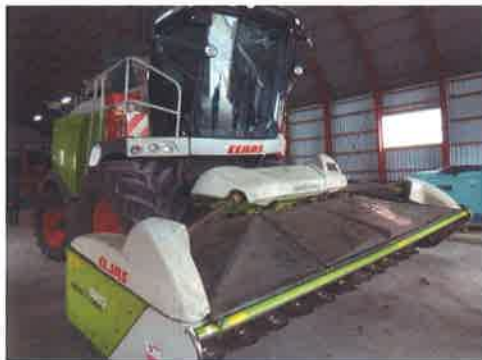
写真① 牧草ダイレクトカッターを装着した自走式ハーベスター
